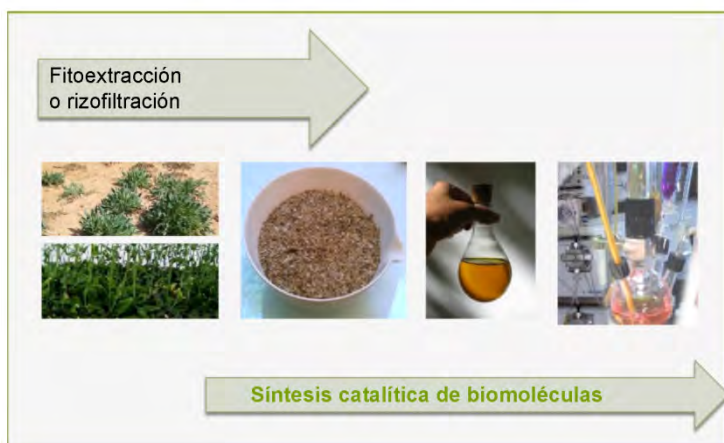
Figura 2. Representación del enfoque de ecocatálisis, de izquierda a derecha: las tecnologías de fitoextracción y rizofiltración generan una biomasa cargada con ETM, que se transforma en ecocatalizadores, cuya estructura es polimetálica. Permiten la síntesis catalítica de moléculas de alto valor añadido con un enfoque ecoresponsable
